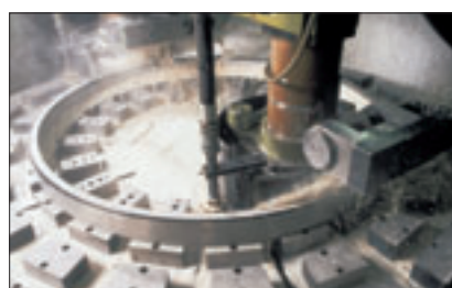
Mecanizado de un aro exterior
