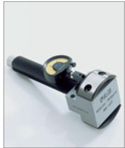
Instrumento de medición del círculo límite FAG MGI21 para ajustar el juego radial o la precarga de rodamientos de rodillos cilíndricos con aro interior desmontable.
