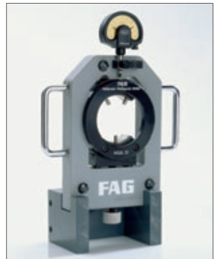
Instrumento de medición del círculo límite FAG MGA 31 para ajustar el juego radial de rodamientos de rodillos cilíndricos con aro exterior desmontable.
