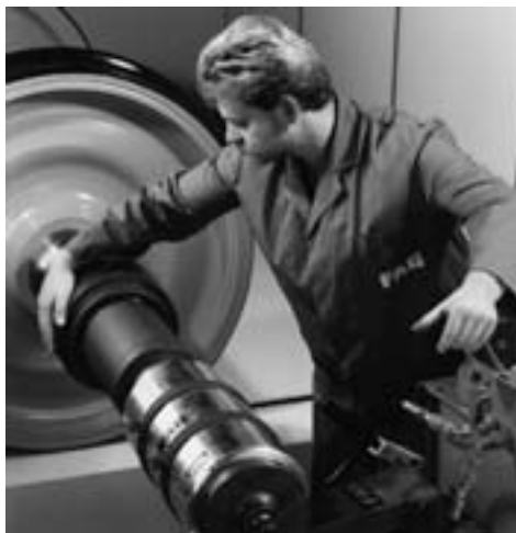
Montaje hidráulico de una unidad de rodamientos para ruedas TAROL sobre la mangueta
